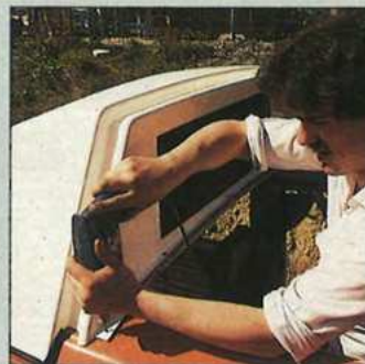
10. Zunächst an der Vorderkante vorbohren und Blechschrauben eindrehen, dann bei offenem Dach die hinteren Laschen der Bugschale festschrauben.
