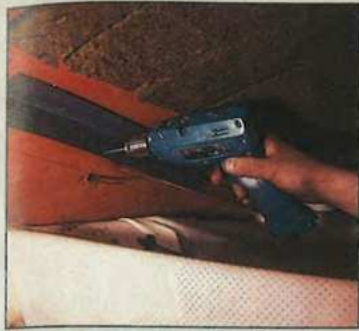
4. Er trägt das neue Carthago-Dach: Der Stahlwinkel muß bei Ausbauten ohne Dachkasten passende Aussparungen für den querlaufenden Dachhimmel-Spanner bekommen.
