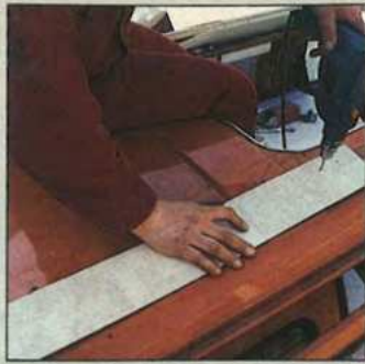
5. Das Bohren der Befestigungslöcher für Scheren und Dämpfer ist eine heikle Sache: Zur Sicherheit erst anzeichnen, zweimal kontrollieren und dann bohren.
