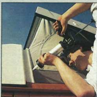
16. Sorgfältiges Abdichten mit Silikon erspart Ärger: Der Zeltanschluß zur Bugschale und die Schalenkante über dem Fahrerhaus sind besonders wichtig.
