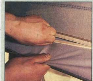
14. Auch die übrigen drei Zeltseiten müssen straff gespannt werden. Holzkeile sorgen dann für Dichtigkeit zwischen den Querrippen des Bully-Dachs.
