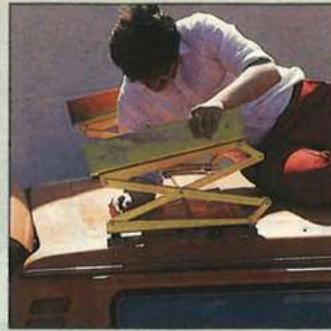
6. Die neuen Dachscheren montieren, dabei mit Elastikmasse satt abdichten. Präzision ist wichtig, damit sich die Dachschale später nicht verzieht.
