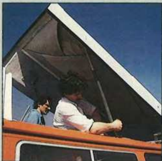
9. Aufstelldämpfer befestigen und bei geschlossenem Dach die vordere Schale justieren: Die Gummilippe des Dachs muß satt in der Abschluß-Sicke sitzen.
